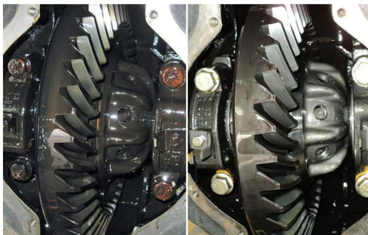
**Figura 7 – Formação de verniz em óleo lubrificante de diferencial devido à oxidação**
