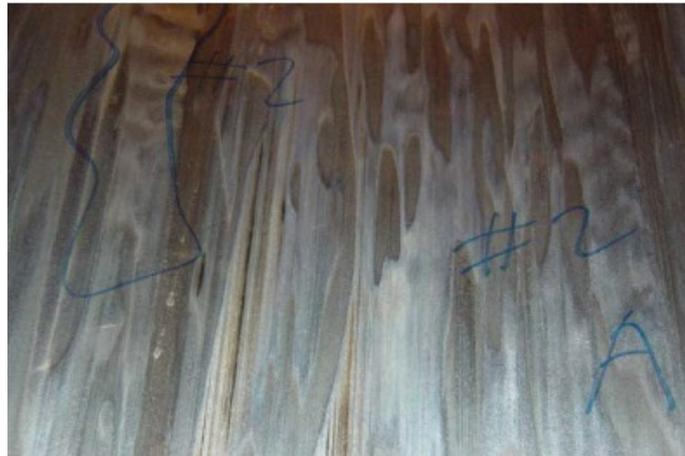
**Figura 3 – Desgaste corrosivo causado por subprodutos da combustão em camisa de motor de combustão interna 4T Ciclo Diesel**
