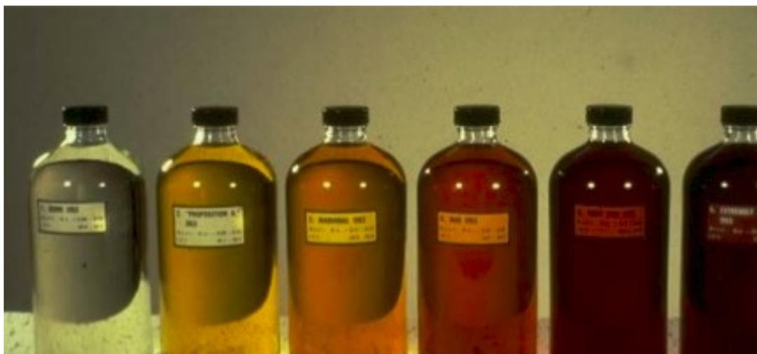
**Figura 6 – Estágios de oxidação em óleo dielétrico**
